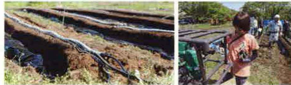
農場に設置されたパイプから自動的に水と液肥が供給される(左)、パイプは手前緑色の液肥混入器と接続されている(右)
